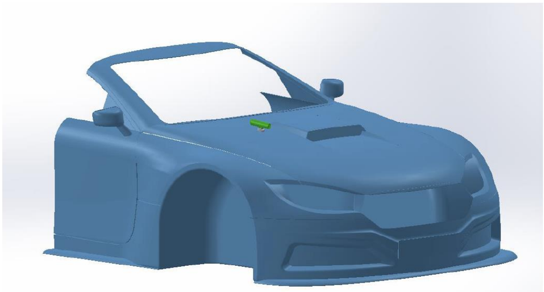
Cámara cilíndrica sobre una superficie, unión con cinta adhesiva a doble cara
