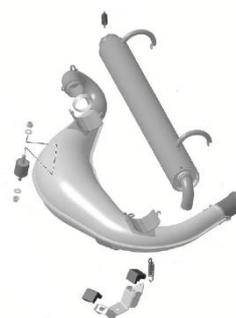
iii. Longitud del cono de salida: 240 mm +/- 5 mm
